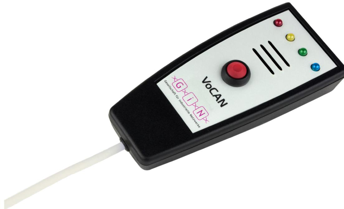
Mit dem VoCAN können, synchron zur Aufzeichnung von Busdaten mit dem Datenlogger, Wahrnehmungen in Audio-Form dokumentiert und später mit anderen Messdaten (z.B. CAN-Daten) abgeglichen werden.
